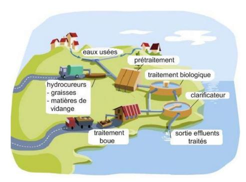
L'assainissement collectif consiste en la réalisation des collecteurs d'eaux usées et de branchements pour chaque propriété; les eaux usées sont ensuite traitées dans une station d'épuration avant d'être rejetées en rivière.
